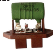
RESISTÊNCIA DO RADIADOR DOBLO, DUCATO, PALIO 1.8, IDEA 1.4, (0.36 OHMS)
